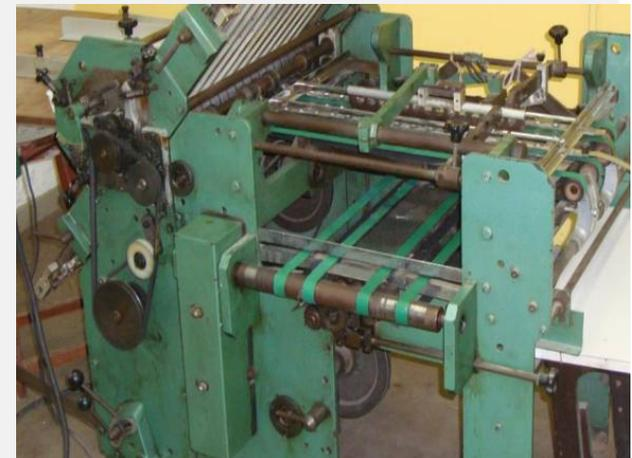
Figura V. 10 - Dobradeira Semi Automática
