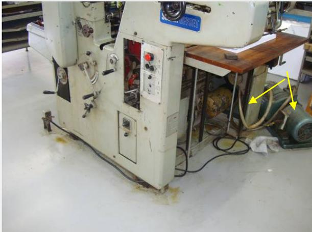
Figura IV. 2 - Bomba Vácuo - Motores
