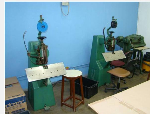
Figura II. 37 – Máquinas de Grampear
