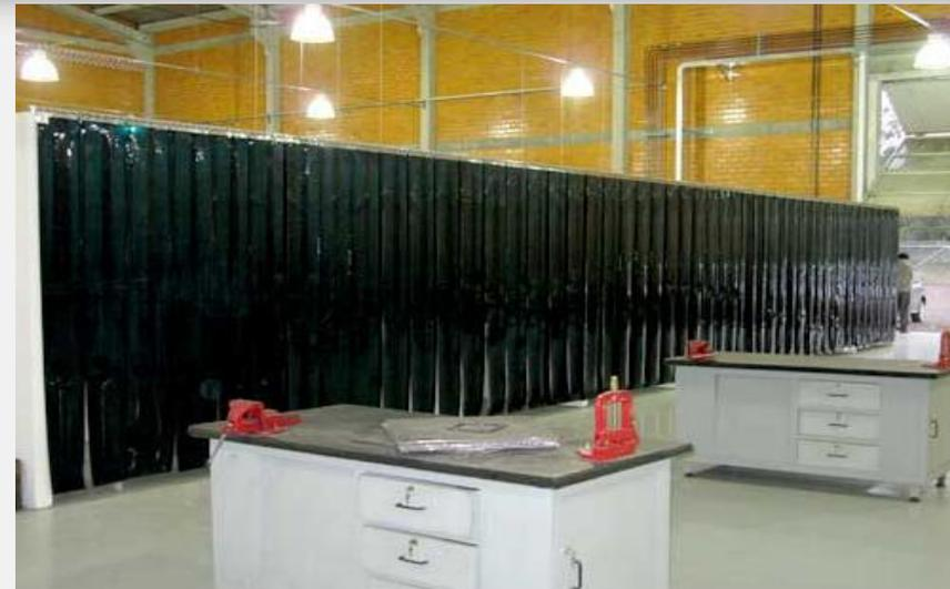
Figura V. 19 - Cortinas de Proteção Ultravioleta e Infravermelho
