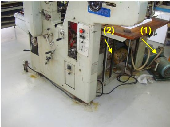
Figura IV. 2 - Bomba Vácuo (1) - Motores (2)
