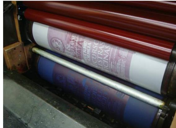
Figura II. 22 - Cilindros de Impressão
