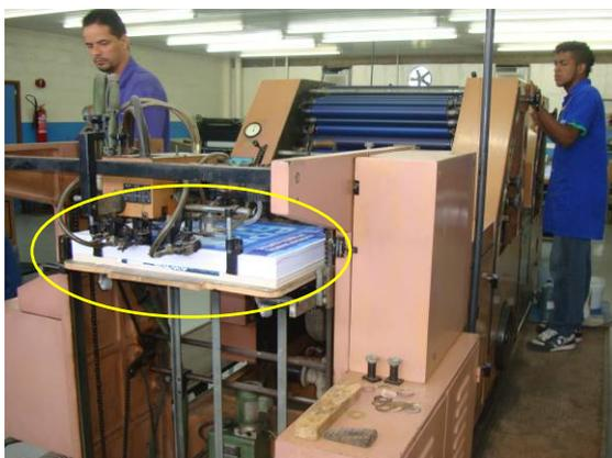
Figura II. 25 - Alimentação da Máquina
