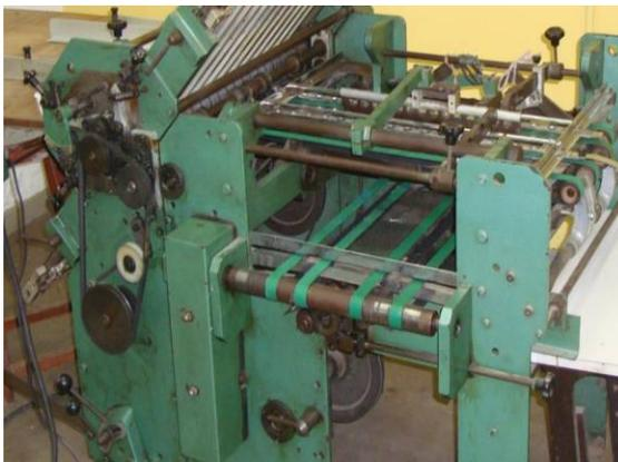
Figura V. 10 - Dobradeira Semi Automática
