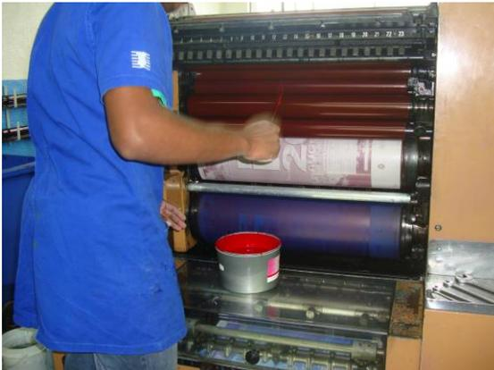
Figura II. 21 - Sistema de Impressão *Offset*
