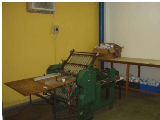
Figura II. 32 - Máquina de Dobragem
