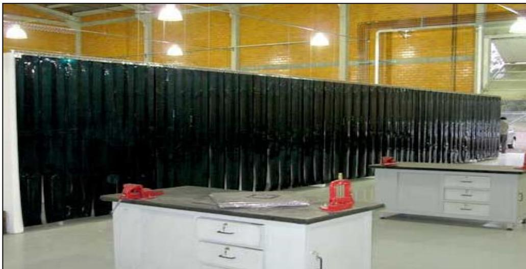
Figura V. 19 - Cortinas de Proteção Ultravioleta e Infravermelho
